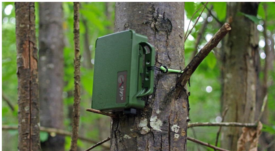
Photo 24 : détecteur d'ultrasons SM-mini accroché en sous-bois
